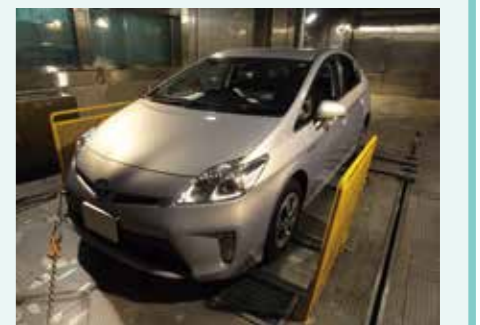
シャーシダイナモム上での試験風景 Landscape on the Chassis Dynamometer Test
